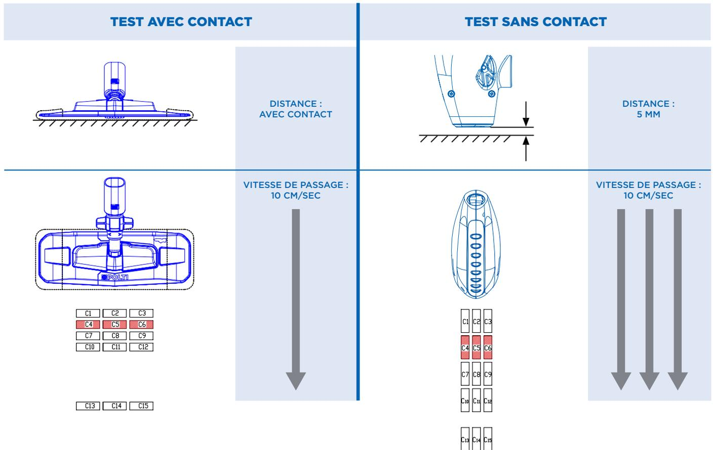
Banc d'essai pour l'évaluation des appareils à vapeur, valable pour les essais «avec contact» et «sans contact»
